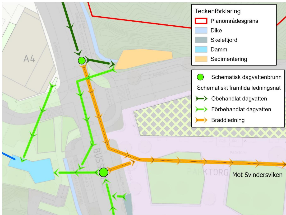
Figur 18. Illustration över förslagen dagvattenlösning vid inlopp till dammanläggning i Sundparken. Redovisade dagvattenbrunnar är bräddbrunnar med flödesfördelande funktion.
